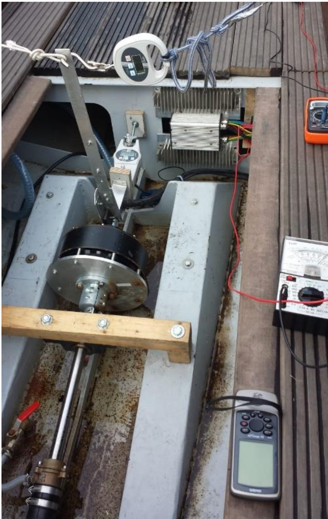
Figuur 1: De innovatieve e-aandrijving in het SEFF stalen MienSkip met de geïnstalleerde meetapparatuur
