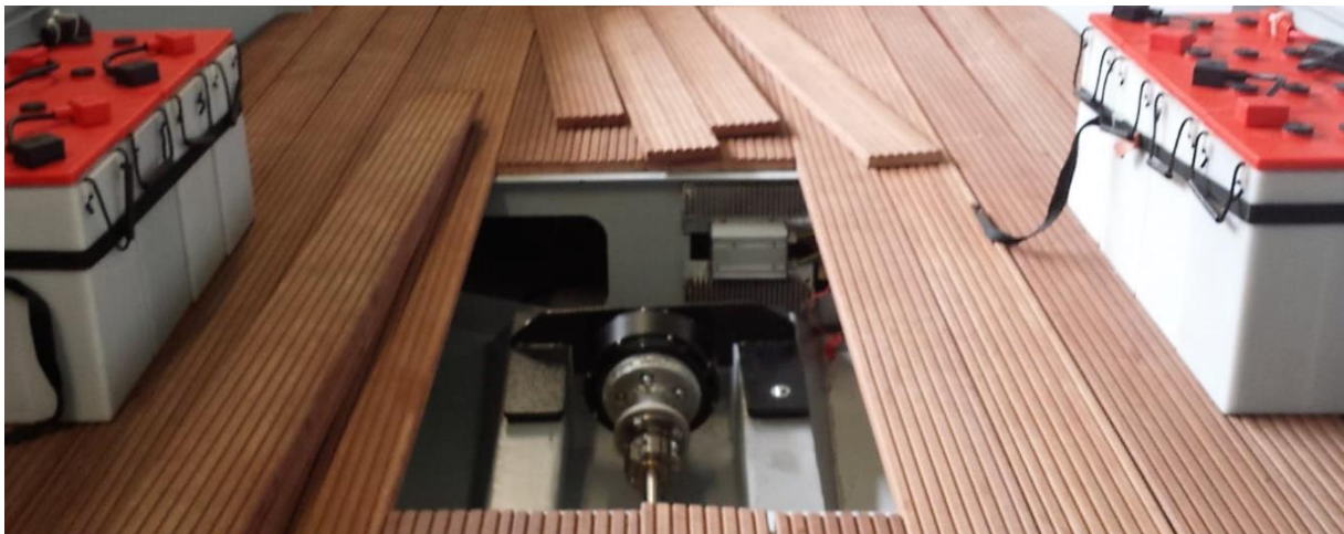
Foto 2 – Ingebouwde naafmotor-met accupakket
